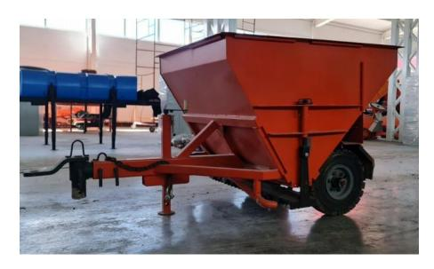
Прицепной пескоразбрасыватель предназначен для посыпания песком придворовых территорий, пешеходных дорожек и тротуаров. Система разбрасывания приводится в действие от колеса прицепа. Может работать с любым транспортным средством оборудованным сцепным устройством. Отсутствие электромоторов, валов отбора мощности, ручная регулировка плотности посыпания и простая конструкция обеспечивают высокую надёжность и простоту эксплуатации в любых погодных условиях.
